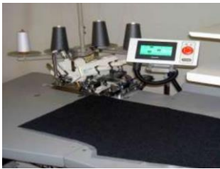
IMAGINEA 12. MAȘINĂ DE SURFILAT AUTOMATĂ (KARTHI KRISHNA S. ET AL.)
