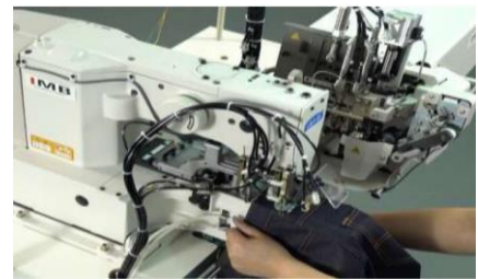
IMAGINEA 14. MAȘINĂ AUTOMATĂ DE CUSUT BUTONIERE (KARTHI KRISHNA S. ET AL.)
