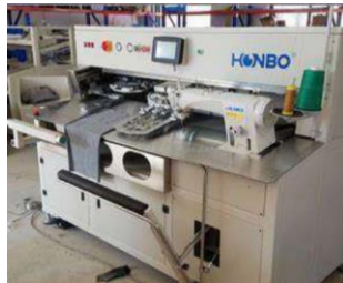
IMAGINEA 13. MAȘINĂ AUTOMATĂ DE APLICARE A BUZUNARELOR (KARTHI KRISHNA S. ET AL.)
