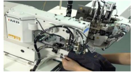
OBRAZ 14. AUTOMATYCZNA MASZYNA DO MOCOWANIA PĘTLI PASKA (KARTHI KRISHNA S. ET AL.)
