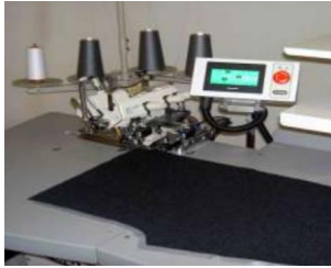
ZDJĘCIE 12. AUTOMATYCZNA MASZYNA DO ZSZYWANIA
