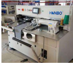
OBRAZ 13. AUTOMATYCZNA MASZYNA DO MOCOWANIA KIESZENI (KARTHI KRISHNA S. ET AL.)
