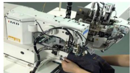
IMAGE 14. ΑΥΤΟΜΑΤΗ ΜΗΧΑΝΗ ΣΥΝΔΕΣΗΣ ΖΩΝΗΣ-ΚΡΟΧΟΥ (KARTHI KRISHNA S. ET AL.)
