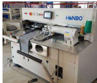
IMAGE 13. ΑΥΤΟΜΑΤΟ ΜΗΧΑΝΗΜΑ ΤΣΕΠΗΣ (KARTHI KRISHNA S. ET AL.)
