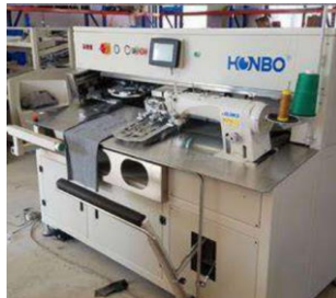
IMAGE 13. MÁQUINA AUTOMÁTICA DE BOLSILLO (KARTHI KRISHNA S. ET AL.)
