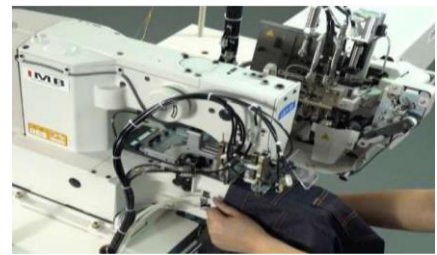
IMAGE 14. MÁQUINA AUTOMÁTICA DE ENGANCHE DE CINTURONES (KARTHI KRISHNA S. ET AL.)
