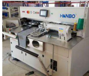
IMAGE 13. AUTOMATIC POCKET-ATTACHING MACHINE (KARTHI KRISHNA S. ET AL.)
