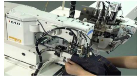
IMAGE 14. AUTOMATIC BELT-LOOP ATTACHING MACHINE (KARTHI KRISHNA S. ET AL.)
